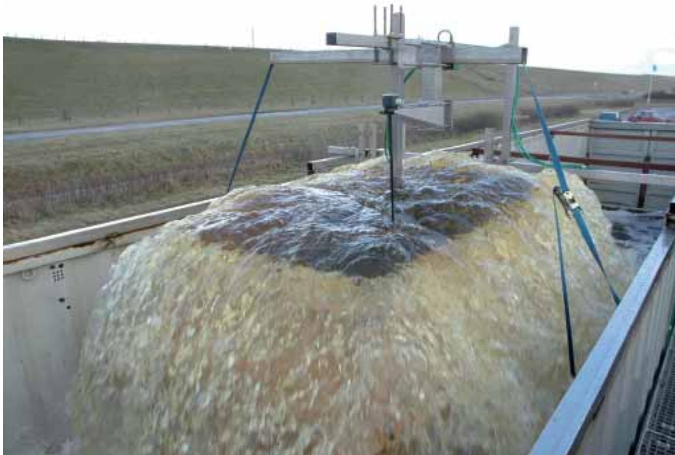
Overstortconstructie met maximale belasting van 2500 kubieke meter per uur.
