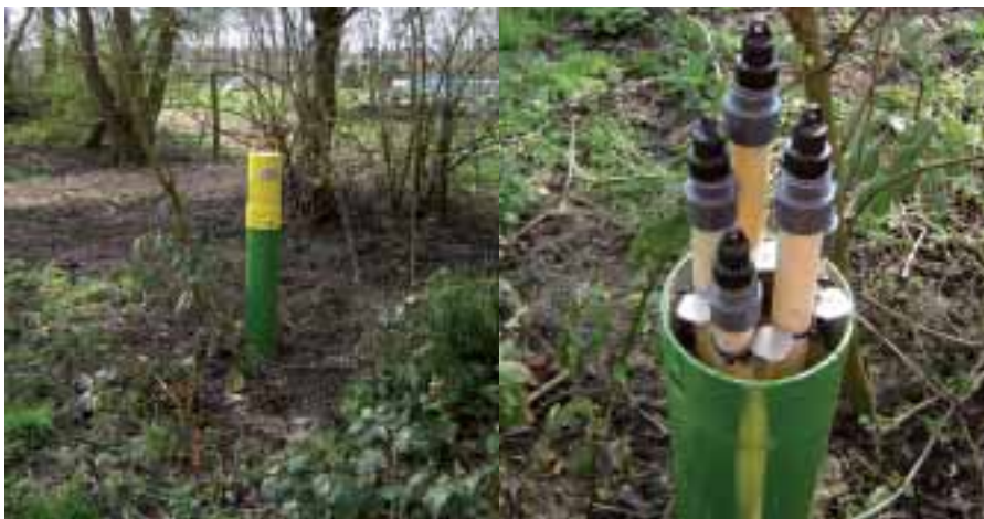
In meetpunt B63G0065 nabij Achthuizen (Goeree-Overflakkee) worden in vijf waarnemingsfilters grondwaterstanden gemeten.
