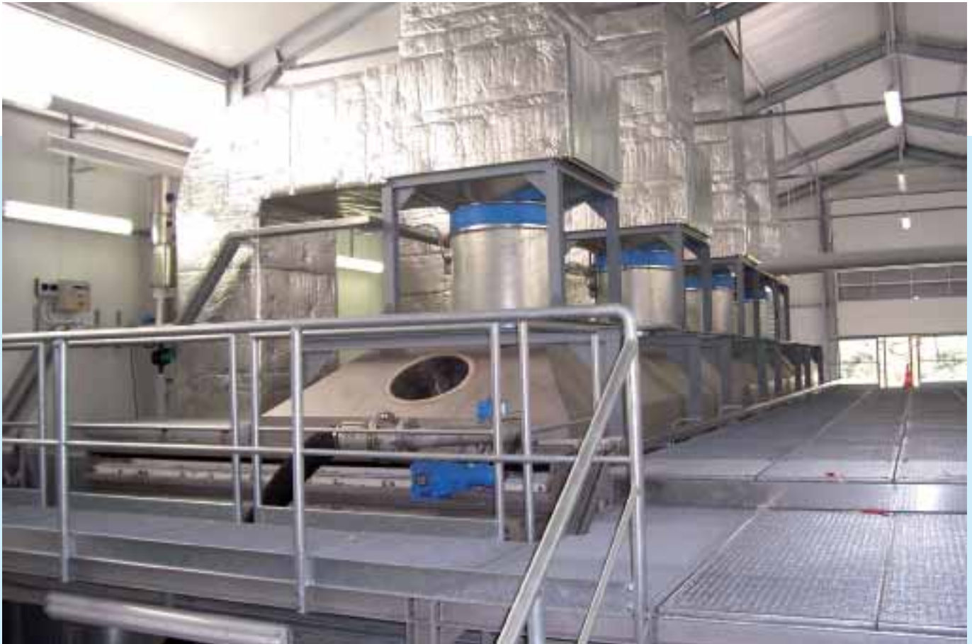
Een slibdroger in het Zwitserse Melligen die op lage temperatuur werkt.
