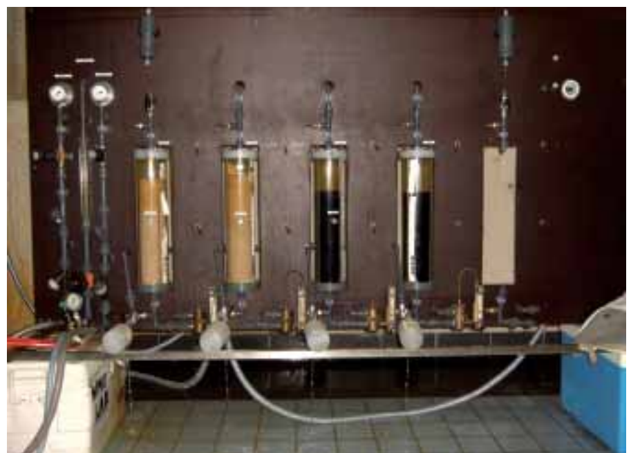
Kolomopstelling met marmorfiltratie en filterzand Harderbroek.
