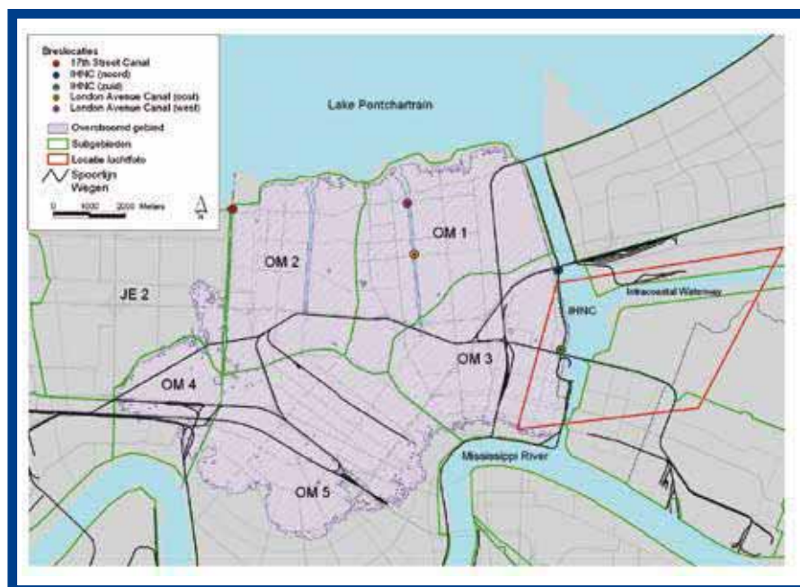
Afb. 1: New Orleans met de locaties van de dijkdoorbraken en de grootte van het overstroomde gebied in het centrale deel van de stad tijdens Katrina. Het kader geeft de omgeving aan van de foto op de volgende pagina.
