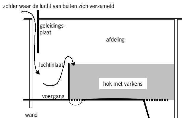
Figuur 12.2 Dwarsdoorsnede van het Oolmansysteem
