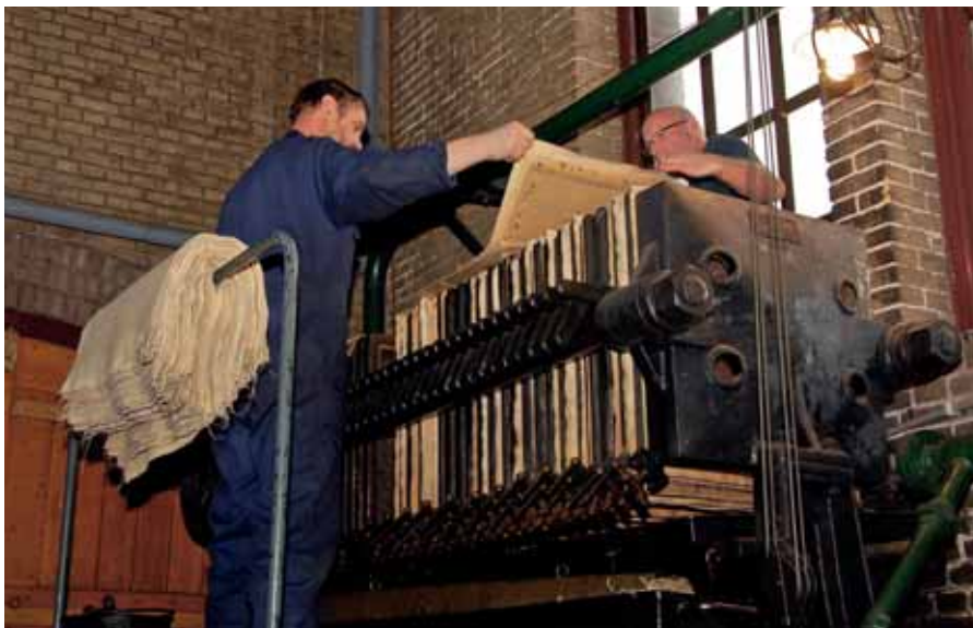
Regelmatig moeten de filters waarmee stoom gereinigd wordt, vervangen worden.
