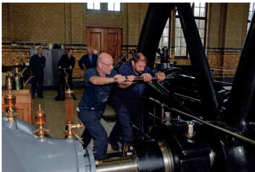
Het vliegwiel moet met de hand in de juiste stand gesteld worden om het draaiende te krijgen.
