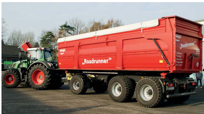
Met de trekker is ook mogelijk, zoals bij deze 47-kuubs Roadrunner met vaste vooras, die aan de dissel vier ton oplegdruk op de trekker overbrengt. De Roadrunner met de Krampe-luchtvering is in Duitsland toegelaten voor 32 ton bij 60 km/u.
