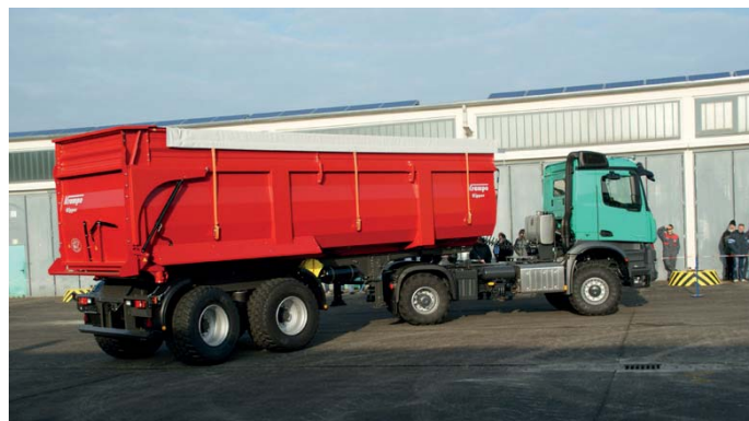
Krampe introduceert deze nieuwe 42,9-kuubs tandem-kipperoplegger KS 900 voor agrotrucks. Deze heeft offroadschoeisel in combinatie met een extra hoge aankoppeling, voor schotelhoogtes van 1,35 tot 1,60 meter.
