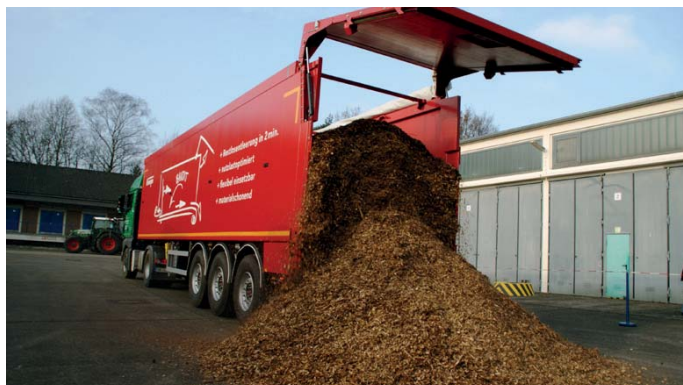
Krampe heeft ook deze pure onroad-vrachtwagenoplegger SB 30/1070 ontwikkeld. De fabrikant mikt daarbij op nichemarkten, zoals het houtsnippertransport. Met de snel en schoon lossende Bandit-bodem ziet het bedrijf kansen ten opzichte van walking floors.
