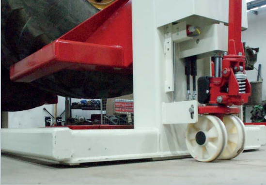
De wielgrepen zijn officieel geschikt tot 800 millimeter brede banden. Rijplaten tussen de wielen voor kleinere bandenmaten zijn beschikbaar.
