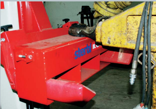
Er zijn verschillende adapters, waaronder een dwarstraverse voor het frame, adapters voor front- en achterhef en deze voor de trekhaak.
