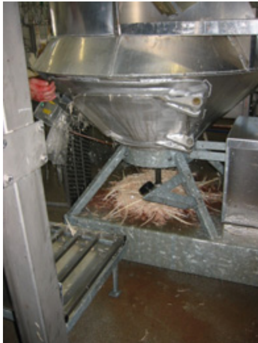
De trommelplukmachine ontdoet de kalkoenen van hun verenpak
