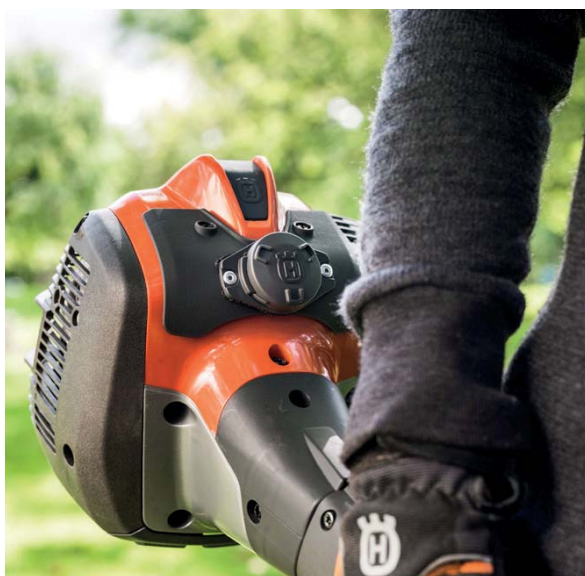
De kern van het fleetmanagementsysteem is deze pulsopnemer, die door de dealer uniek wordt gecodeerd voor de desbetreffende machine.
