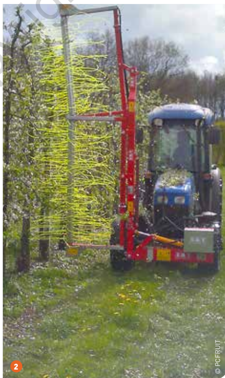
1 Bij de Tree Darwin bepaalt de rotatiesnelheid van de veters hoe sterk er gedund wordt. 2 De BMV-dunmachine heeft 2 rotoren, waardoor men lokaal sterker of minder sterk kan dunnen
