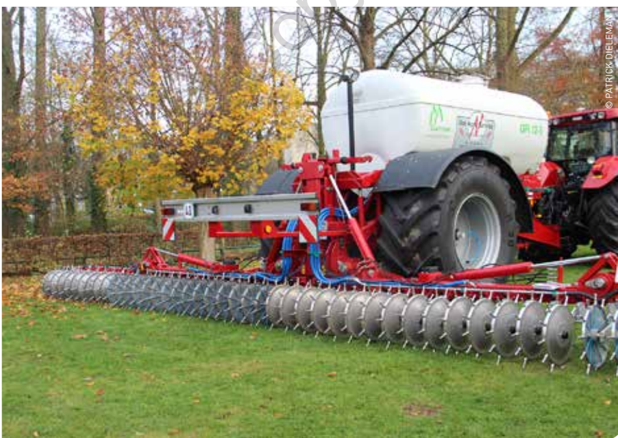
De spaakwielbemester heeft als voordeel dat hij het spuiwater vlak bij de wortels injecteert. Dit is bijvoorbeeld heel handig op grasland.
