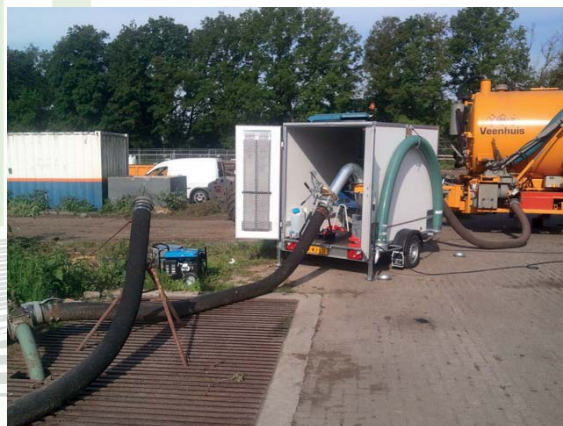
Met een mobiele meetunit probeert Veenhuis bij zoveel mogelijk monsters de NIRS-apparatuur te vergelijken met gewone mestmonsters.
