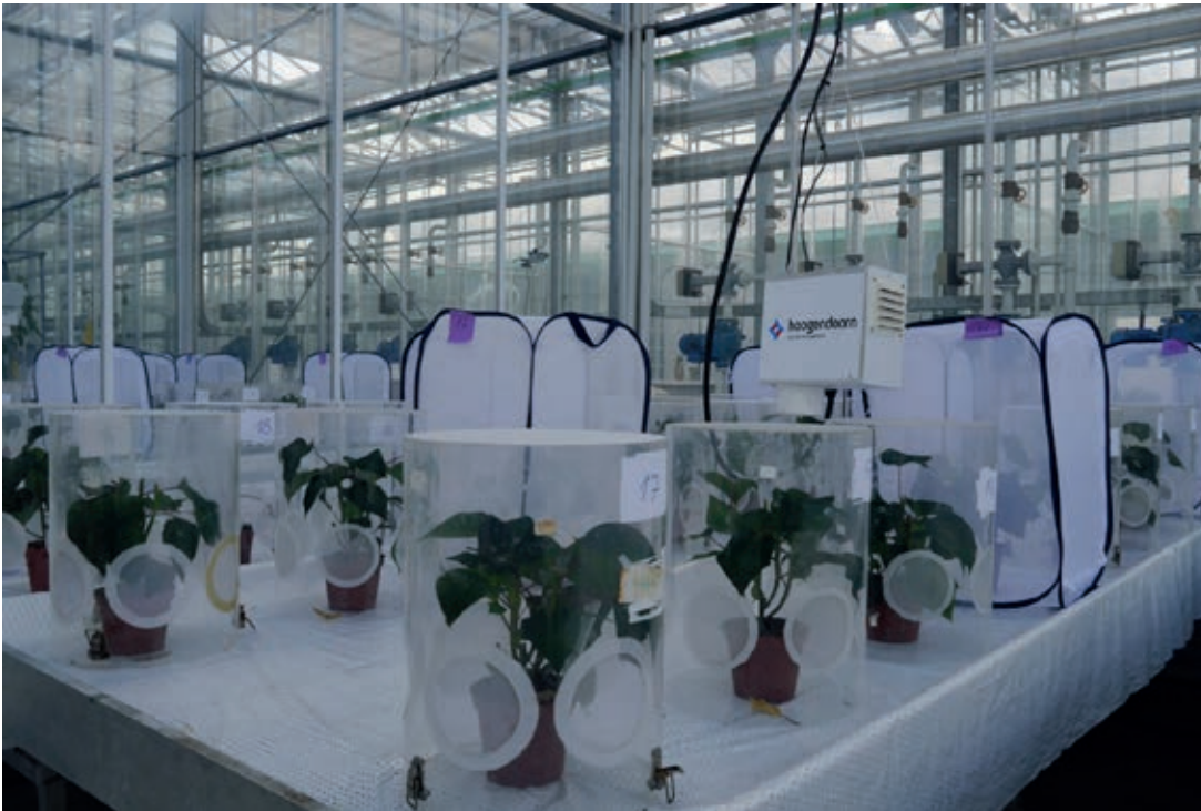
Figuur 6.3 Opstelling kooiproef in één van de kassen.
