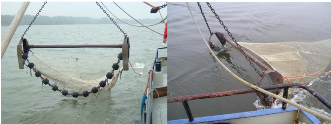
Afbeelding 2.2. Bemonstering met de 3 meter boomkor.
