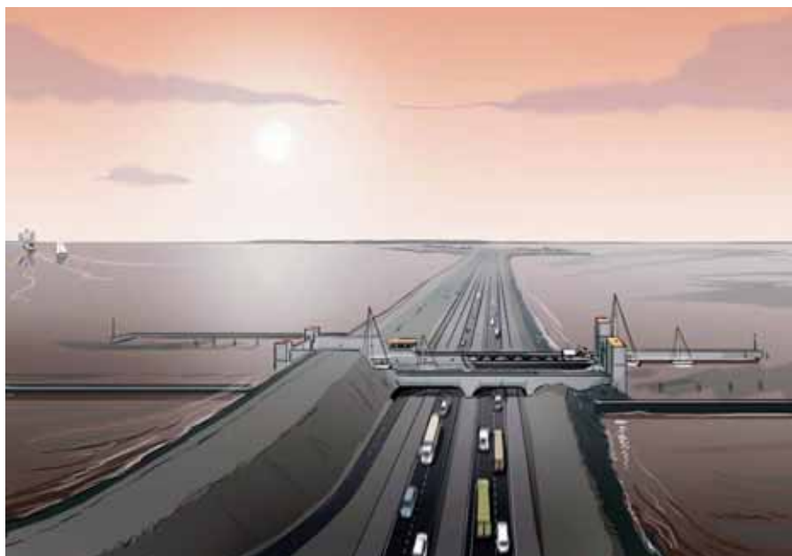
Het voorgestelde naviduct van Rijkswaterstaat bij Kornwerderzand.
