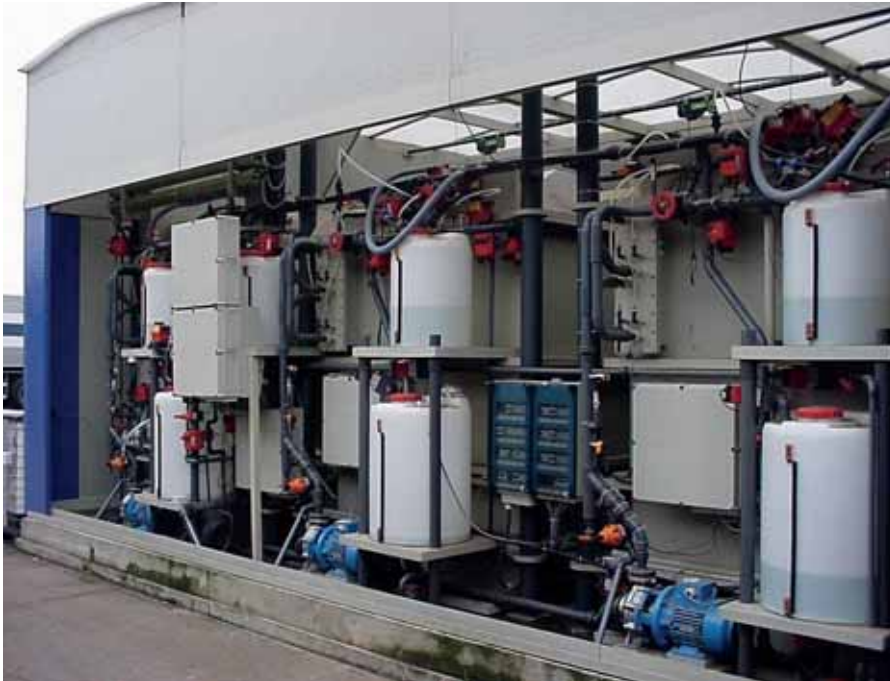
Installatie voor het behandelen van mestwater met membraanstechnologie.
