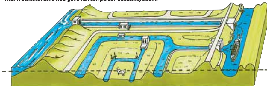
Afb. 1: Schematische weergave van een polder-boezemsysteem.
