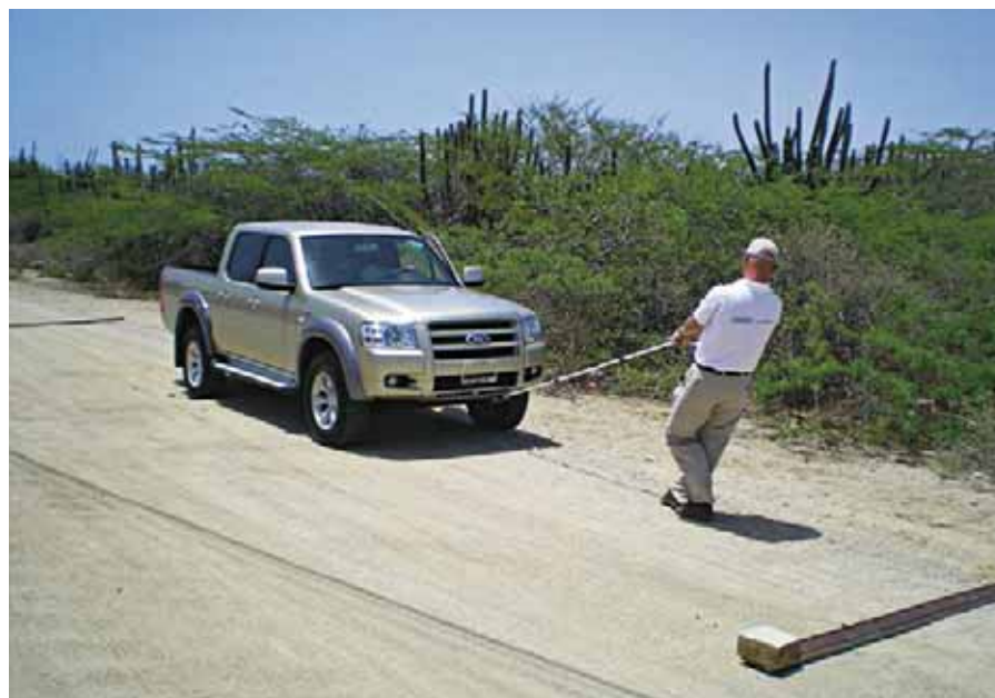
Een test om een auto vooruit te trekken met drinkwaterbuizen en -fittingen (foto: Wavin).
