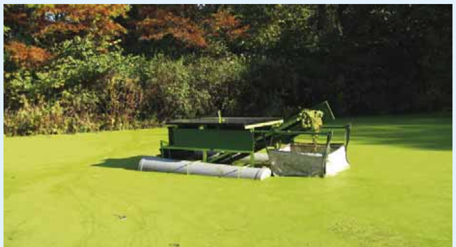
Het zelfstandig werkende Krooswiel van het Hoogheemraadschap van Delfland en Bom Aqua BV.
