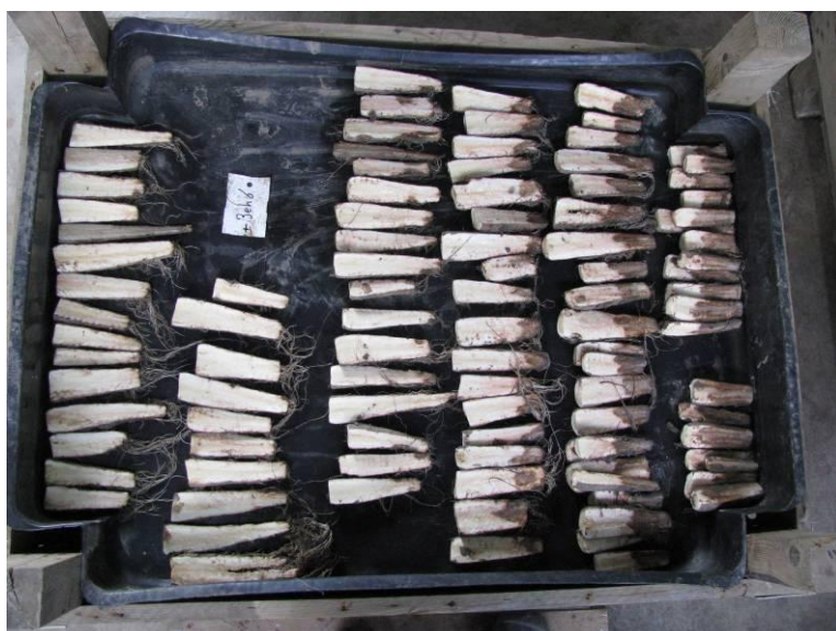
Foto 9: doorsnede pennen met bruinverkleuring door Phytophthora, behandeling 6 (AquaNox 0,5 % hoge dosering), 12 april 2012.
