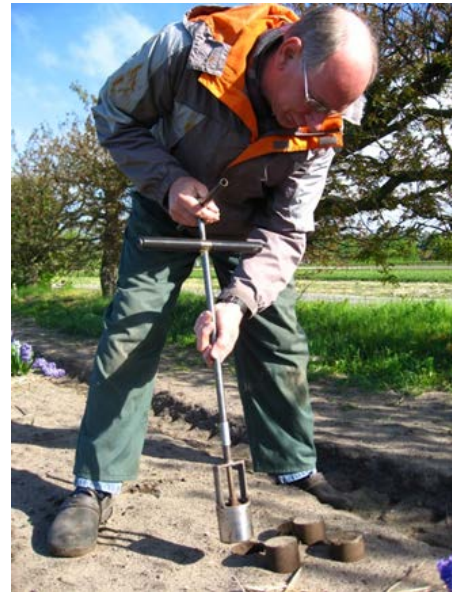
Het steken van ongestoorde grondmonsters voor bepaling van het vochtvasthoudend vermogen (mei 2013).
