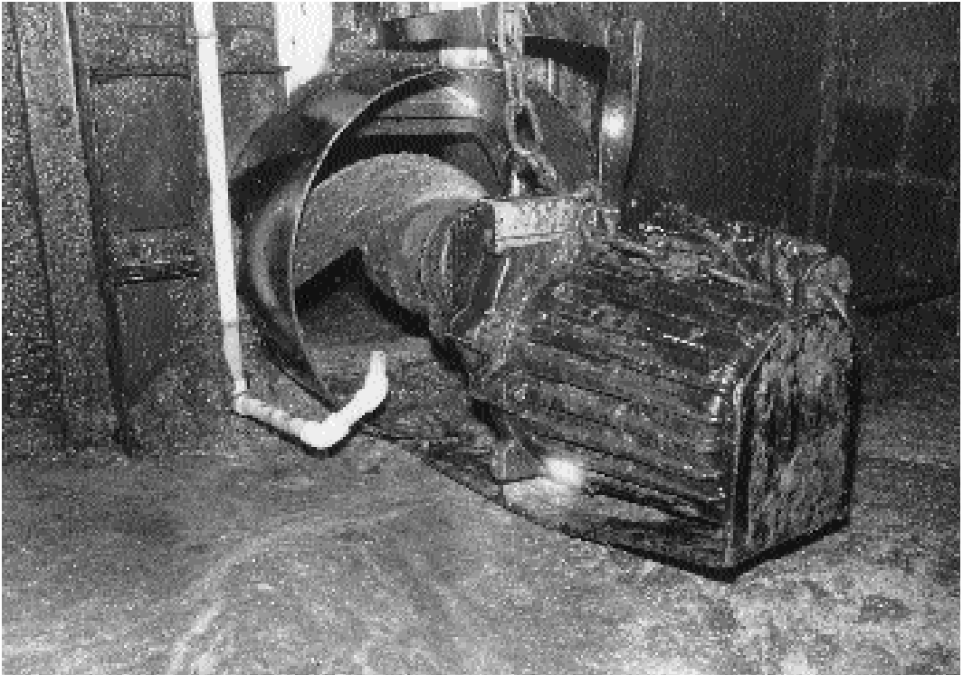
Bij gescheiden afvoer van mest en urine is regelmatig mixen met een electromixer (b.v. via een tijd klok) een methode die goede (meng)resultaten geeft.
