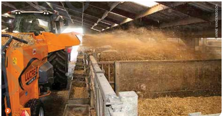
1 Het gamma Spirmix en de verlaagde Spirmix L getrokken verticale mengvoederwagens reikt van 8 tot 24 m 3 . Ook voor deze machines is er volgens invoerder Steeno een mooie toekomst weggelegd in ons land. 2 De gedemonstreerde C-Kator 32 beschikt over een volume van 3 m 3 . Via de laterale blaaspijp, aan de rechterzijde van de machine, kan je het stro tot 10 m ver verspreiden.
