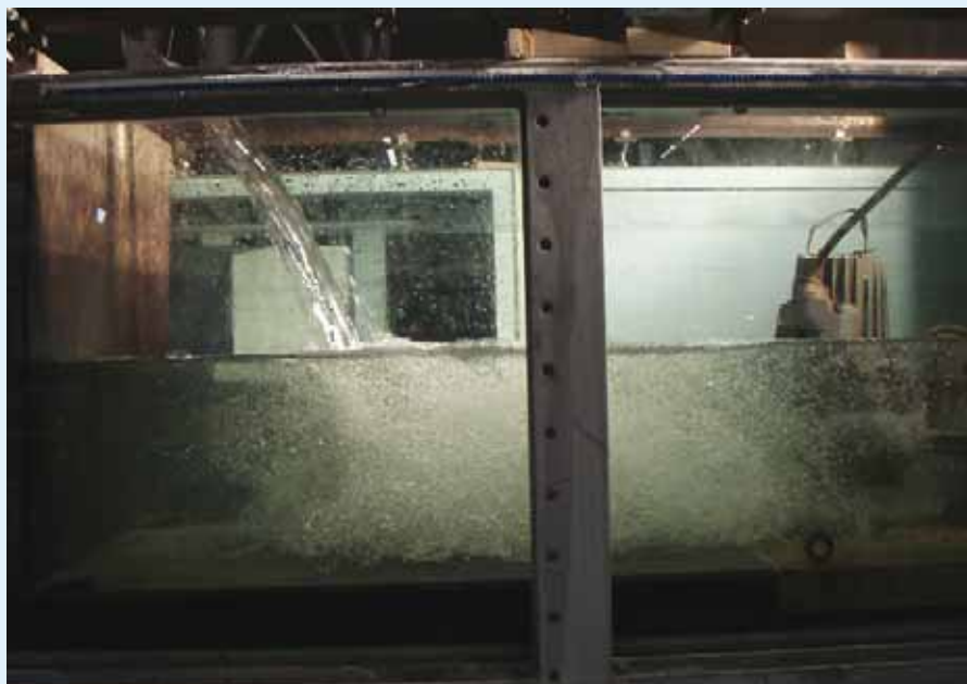
Impressie van de luchtinname zonder afscherming bij 40 cm waterdiepte, een debiet van 14,5 l/s en een afstand tot de pomp van 1,5 meter.
