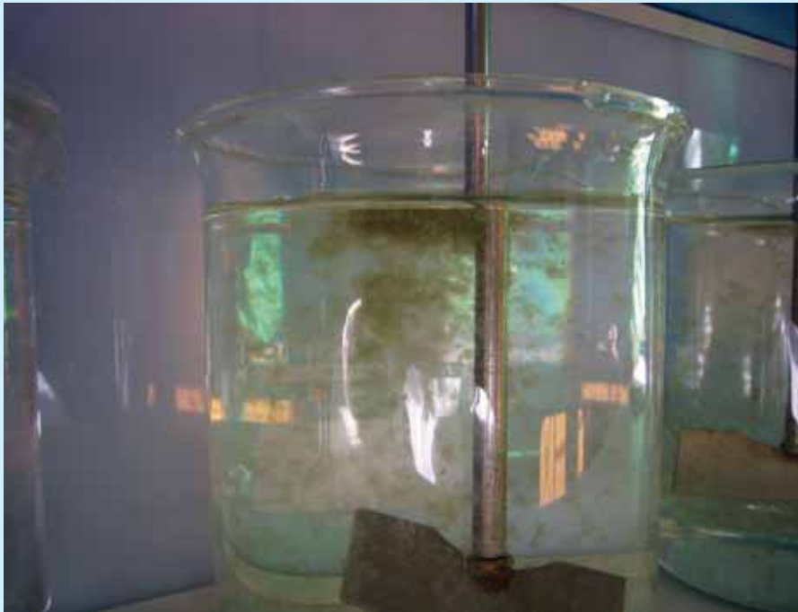
De proef met een bekglas laat duidelijk zwevende vlokken zien.
