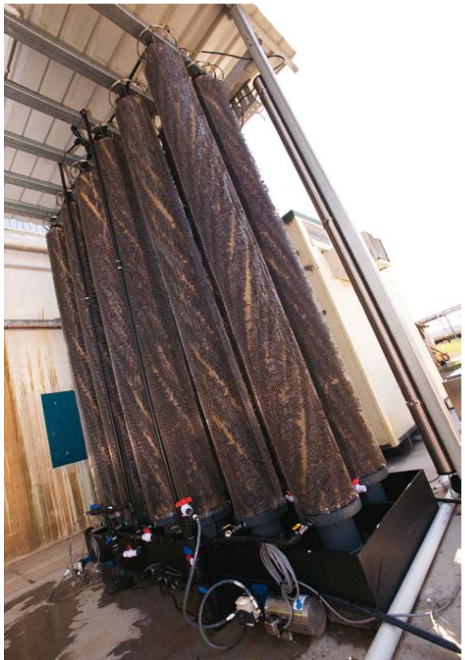
Eerste generatie MFC-pilotinstallatie van The University of Queensland bij de Foster's bierbrouwerij (foto: University of Queensland).
