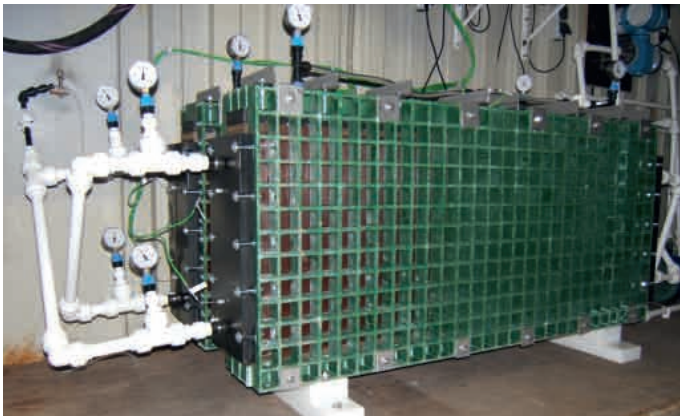
Opstelling met een gemodificeerd membraan voor membraandestillatie van afvalwater.
