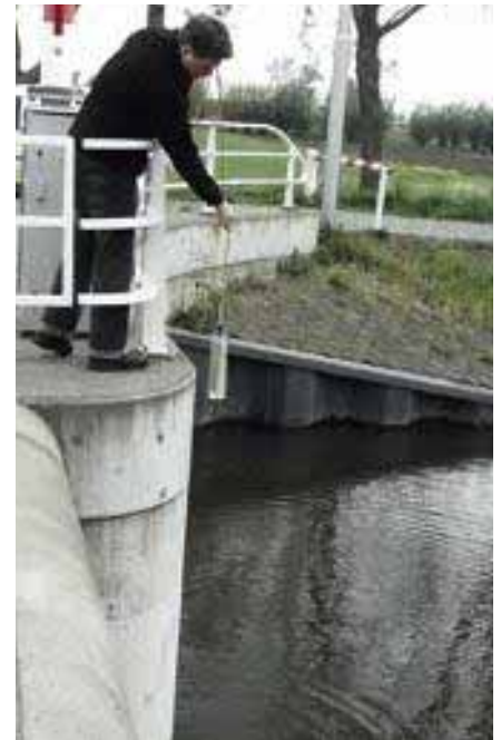
Een medewerker van Waterschap Rivierenland neemt met een Rutnerfles een watermonster.
