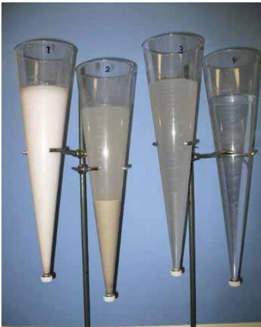
Vier soorten water, elk na 30 minuten bezinking: inkomend water van Unipol (1), scheiding bacteriën van water (2), water naar water-luchtextractie (3) en water uit water-luchtextractie (4).
