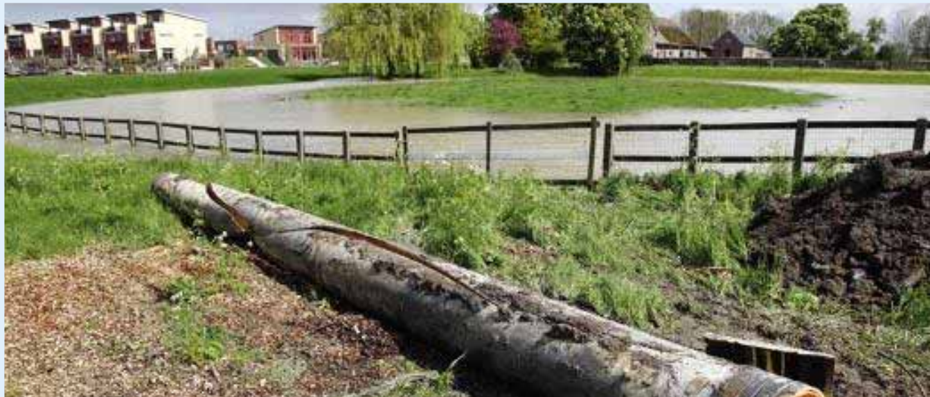
De gescheurde leiding (500 mm), met op de achtergrond het ondergelopen weiland (foto: Fotoburo Martin Droog).
