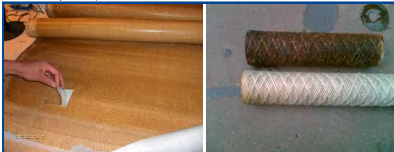
Biofouling in de RO-module die rechtstreeks werd gevoed met UF-permeaat na ruim 50 dagen looptijd (foto links). Kaarsenfilters na zeven dagen looptijd (foto rechts), het bovenste kaarsenfilter is gevoed met UF-permeaat, het onderste met BAKF-filtraat.
