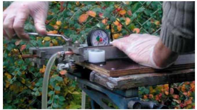
Veldopstelling voor het nemen van ^3\text{H}/^3\text{He} monsters (links) en (rechts) dichtschroeven van ^3\text{H}/^3\text{He} monster op speciale workmate (foto's: Frido van der Horst).
