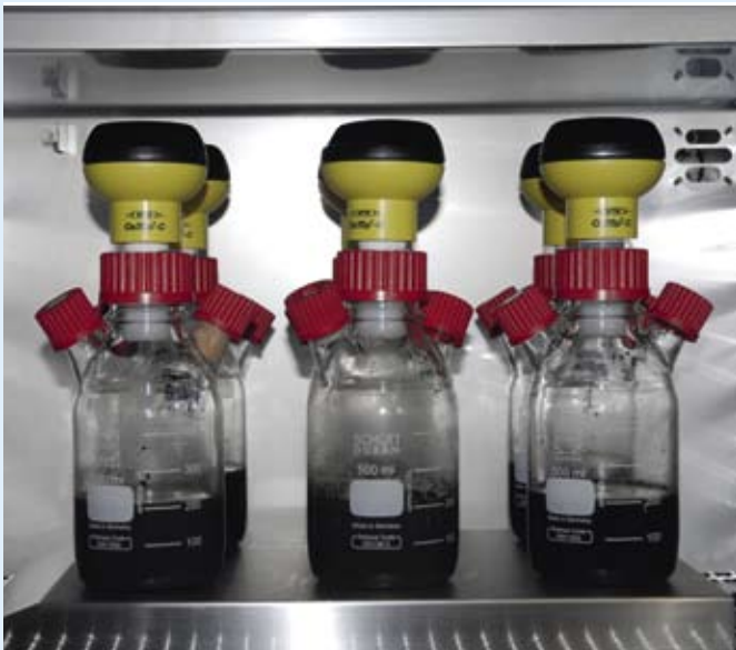
Vergistingstesten op laboratoriumschaal.
