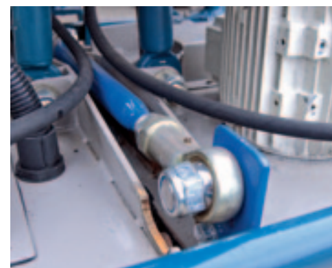
■ Den Hollander monteerde een stang met kogels tussen de middelste maaidekken.
