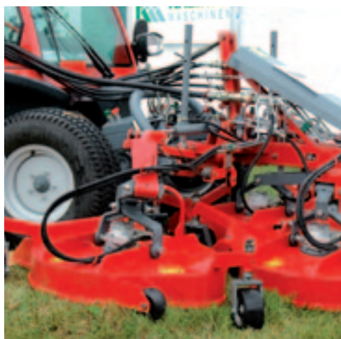
Olieslangen hebben geen problemen met een bocht en zijn dus geschikt voor het gebruik op opklapbare maaidekken.
