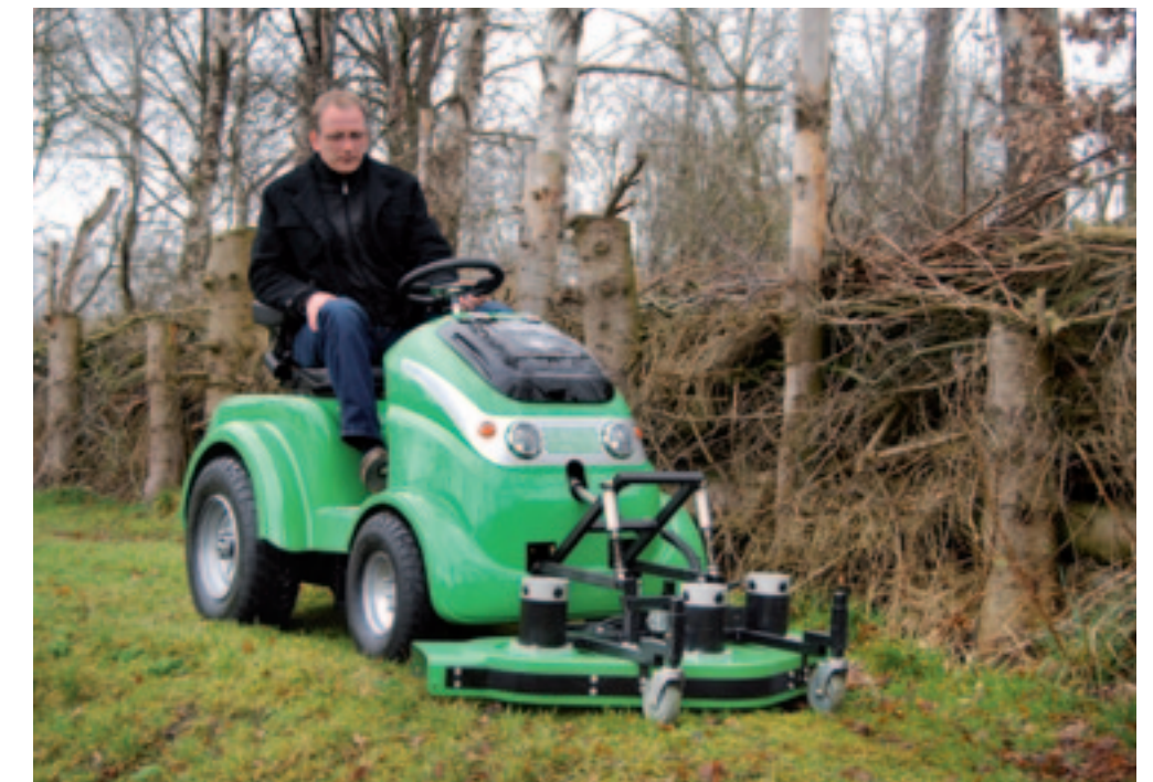
Zitmaaiers met accu-aandrijving komen langzamerhand in beeld, maar zijn met hun beperkte inzetduur voorlopig vooral aardig voor de particulier met een vrijstaand huis en een modale gazonsgrootte.
