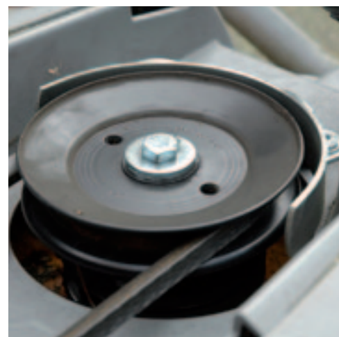
Aandrijving van de maaimessen met riemen is eenvoudig en goedkoop. Aandachtspunt is dat de riem goed op spanning blijft.
