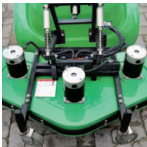
Het maaidek van de FM-30 elektrisch aangedreven tuintrekker van Frisian Motors.
