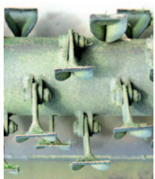
Een detailfoto van de klepels op de spiraalrotoras van de Spearhead Trident Park.
