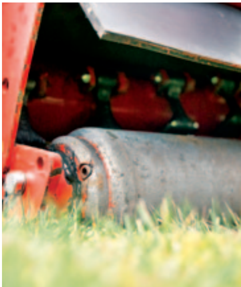
De Seppi M. Sport heeft een diepterol met grotere diameter. Dat verdicht minder.
