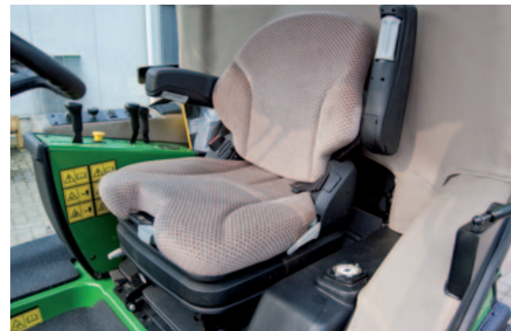
De cabine van de 1585 waarmee Tuin en Park Techniek reed, is voorzien van de optionele luchtgeveerde stoel. De kleur van de stoel en de cabinebekleding geven de cabine de John Deere-look. Voor wie de cabines van grotere John Deere-machines kent, voelt het een beetje als thuis komen.
