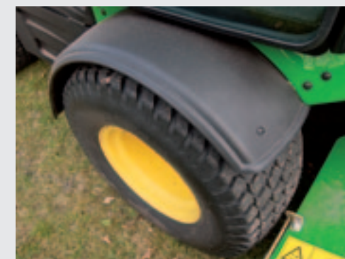
Door de voorwielen om te draaien, komt de maaier op breder spoor. Deze spatborden zijn dan wel wenselijk.
