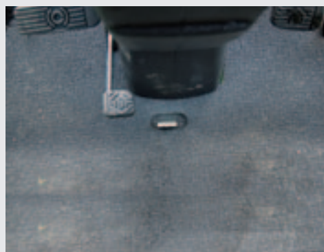
Door het 'lipje' naar voren te drukken, kun je met je rechervoet de parkeerrem activeren. Links ervan zit het differentieel slot.
