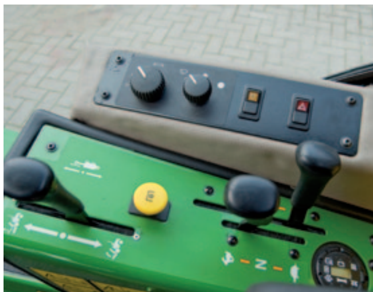
Alles wat je nodig hebt om te kunnen maaien, alsook bediening voor verlichting en ruitenwisser, zit binnen handbereik. De 1585 kenmerkt zich ook door de mechanische Hi-Low.
