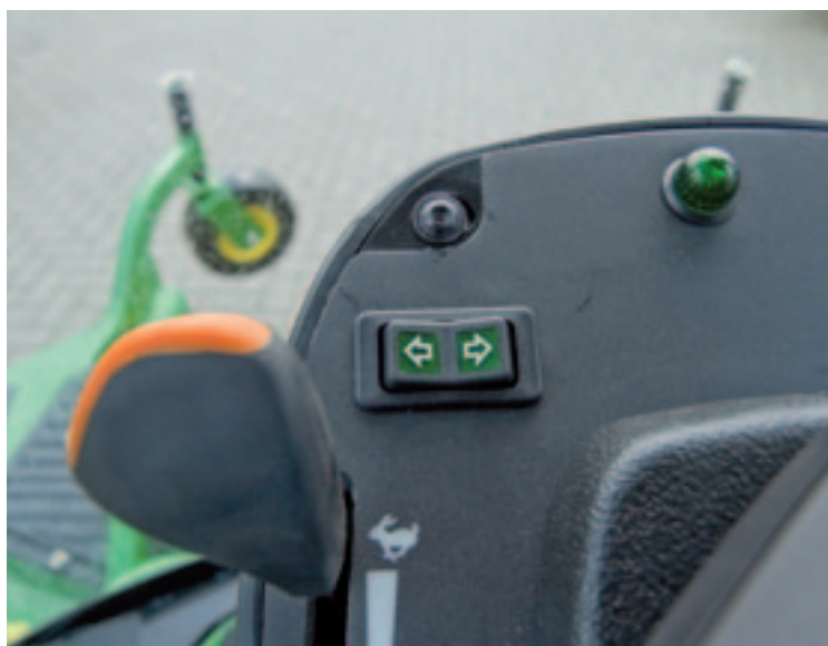
De chauffeur kan de stuurkolom naar zich toehalen. Op de stuurkolom zelf zit niet meer dan het stuur, de tuimelschakelaar voor de richting-aanwijzers en het handgas.
