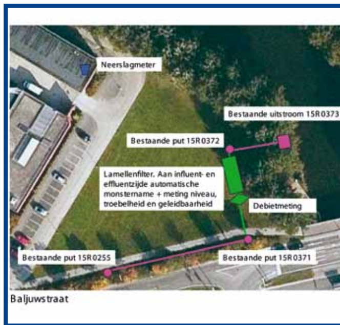
Invulling rioolput als onderzoekslocatie.
