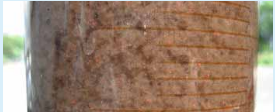
Slib uit de Demonreactor. De deammonificerende bacteriën vormen duidelijk zichtbare rode korrels.
