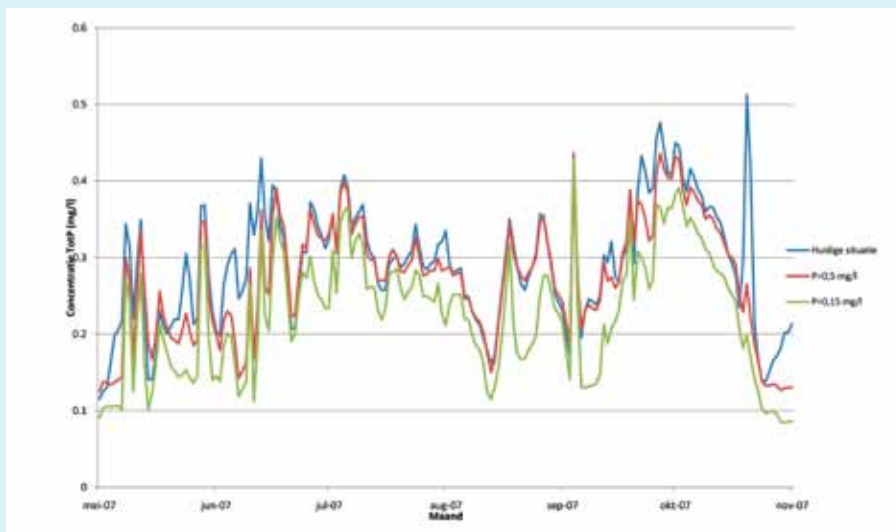
Afb. 4: Berekende concentratie totaal-fosfaat in het Noordhollands Kanaal nabij de rwzi Beemster voor en na verbetering van de rwzi.
