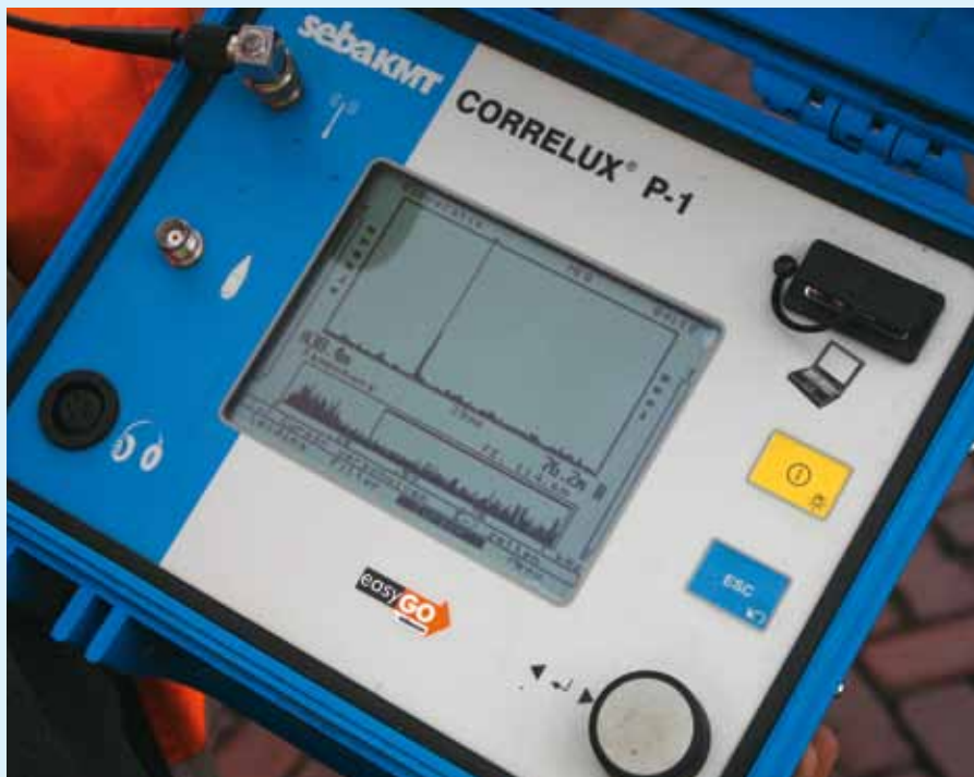
Een verborgen lekkage wordt zichtbaar doordat de grafiek een uitschieter (in geluid) weergeeft.
