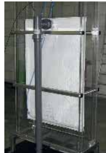
Prototype van de ondergedompelde doekmodule (1,6 m 2 ).
