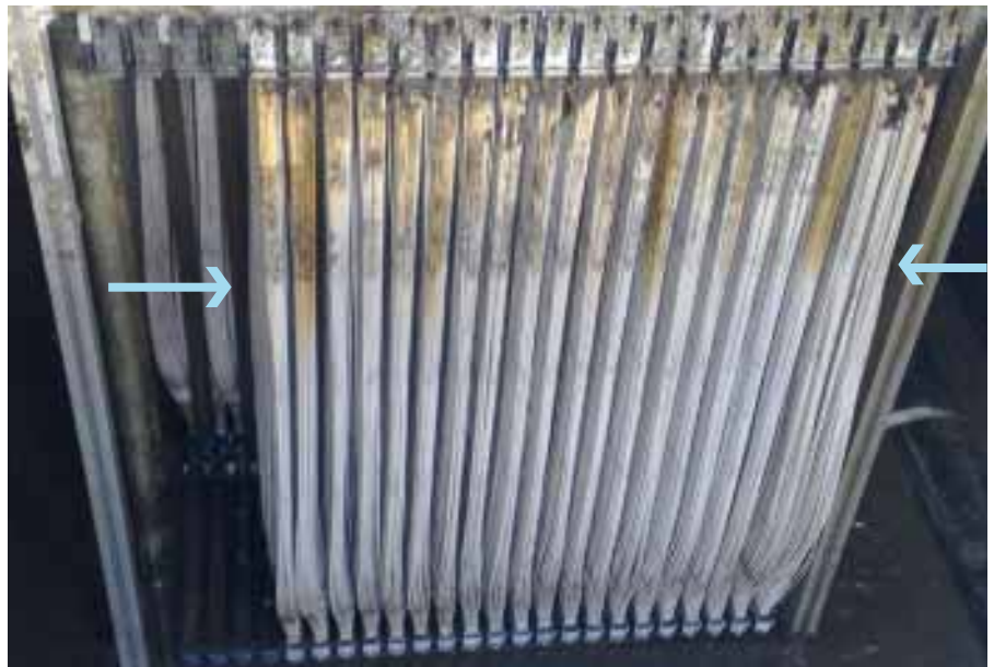
Effect van beluchting (beluchting aan vanaf het niveau van de pijlen).
