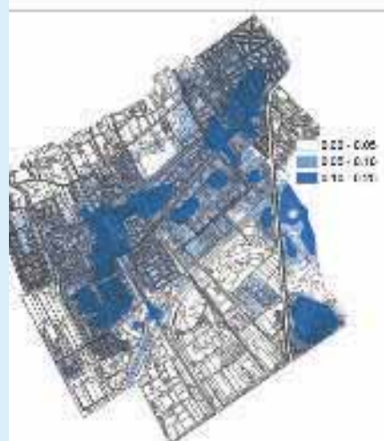
Afb. 1: De berekende stijging van de grondwaterstand als gevolg van een neerslagtoename van 7 procent. De resultaten zijn weergegeven in bovenaanzicht.
