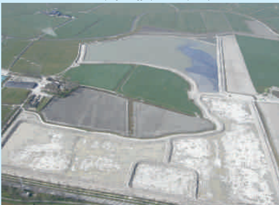
Onderdeel van het waterbodembeheer: opslag van baggerspecie in een depot nabij Winsum.
