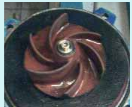
Magneetbehandeling bij slibontwatering: struviet wordt niet langer afgezet op onder andere de pomprotor.
