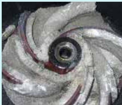
Magneetbehandeling bij slibontwatering: struviet wordt niet langer afgezet op onder andere de pomprotor.
