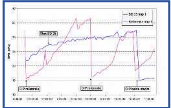
Afb. 3: Genormaliseerde drukval in trap 1 van de stack met BD 25 en in de referentiestack.
