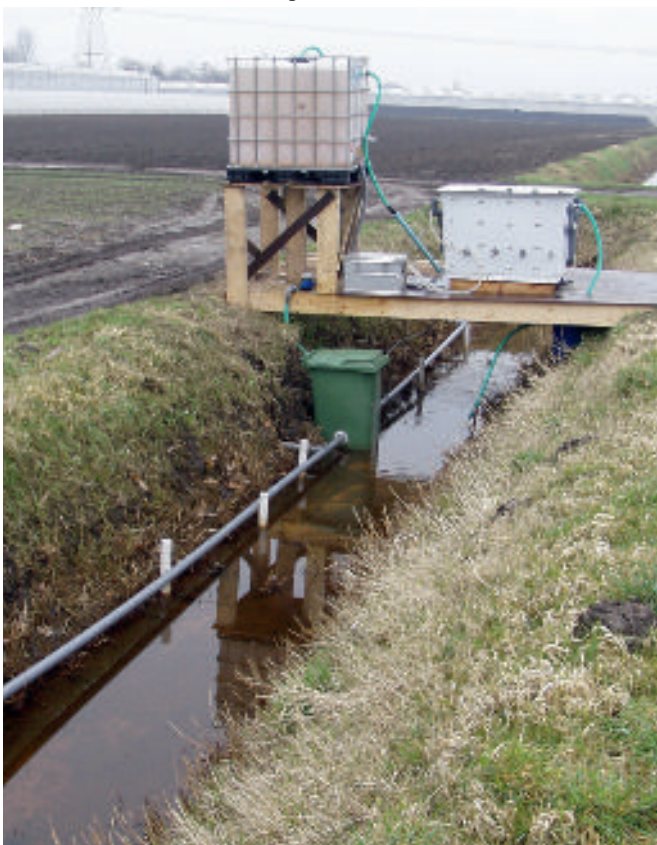
Proefopstelling met ethanoldoserende reactor in Prinsenbeek: a) opstelling met gekoppelde drainagebuizen, buffervat en reactor, b) detailaanzicht van binnenzijde reactor met schotten en kunststofslangen met ethanol.
