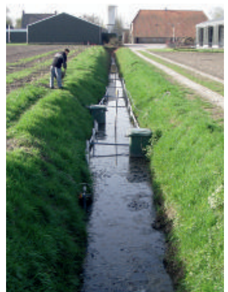
Proefopstelling met omhulde drains in Noordhoek: a) Aanleg van omhulde drain, b) Sleuf met drain en mengsel van houtsnippers en zand, c) Proefopstelling met verzameldrains.
