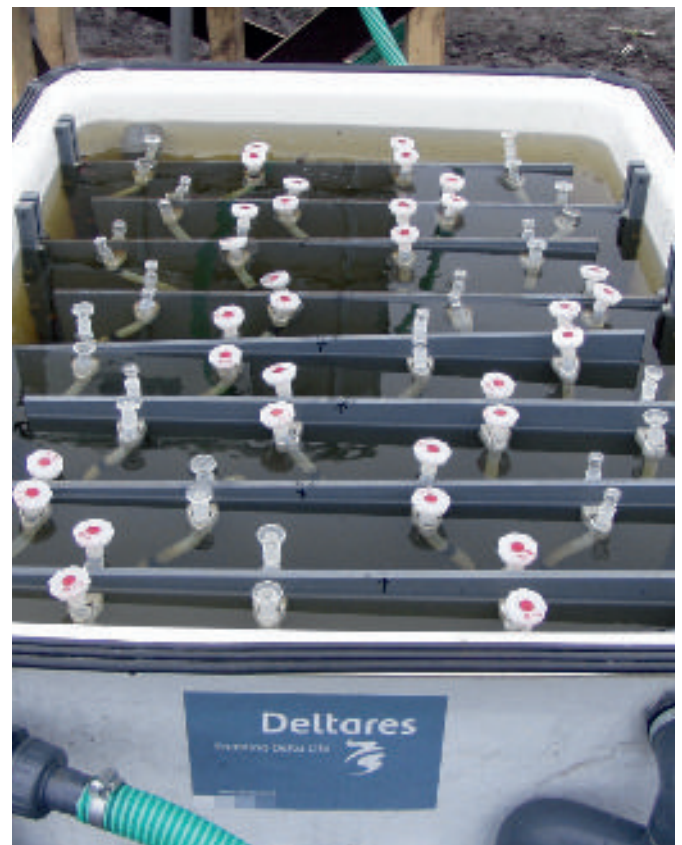
Proefopstelling met ethanoldoserende reactor in Prinsenbeek: a) opstelling met gekoppelde drainagebuizen, buffervat en reactor, b) detailaanzicht van binnenzijde reactor met schotten en kunststofslangen met ethanol.
